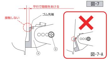
4 ハシゴの取付け位置を守り、リアドアを半分開いた状態で ⑦フック下の先端をリアドアの下端に引っ掛け、 ④ベース金具下のナット部に⑭キャップボルトM8、⑮平座金M8 を⑯L型レンチにて左右均等にゆっくり締め込みます。 締め込む際はハシゴが下がるように軽く手などで加重を加えながら 締め込みを行ってください。
