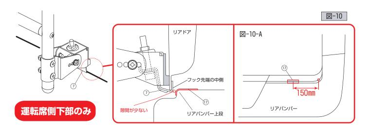
7 最終の締付け状態の確認を行います。作業は2人で行ってください。 ハシゴを装着後、1人がハシゴに乗り、もう1人が下から⑦フック下の状態を確認します。 上下左右に揺らしてもズレ動かない状態が最も良い状態になります。 ⑦フック下をつまんだ際に"カタカタ"と動くようであれば締付不足の為、動かなくなるまで再度締込みを行ってください。必要以上に締め込み過ぎると、逆にフックが外れ易くなり、リアドアが変形する恐れがありますので注意してください。
