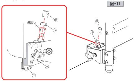
9 最後にハシゴを前後左右に揺すり、ガタツキが無い事を確認してください。 ガタツキがある場合は使用せず、再度取付け方法を確認してください。
