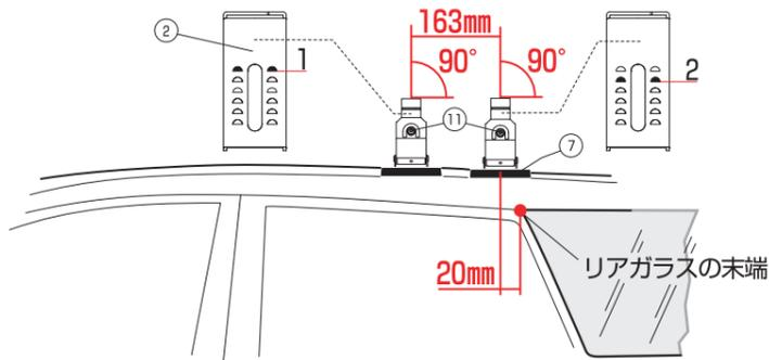
1セットはリアガラスの末端から前へ20mmの所に⑦ベースゴムの中心が来るように載せ、もう1セットはさらに163mm前方に載せます。
