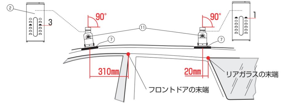
1セットはフロントドアの末端から前へ310mmの所に⑦ベースゴムの中心が来るように載せ、もう1セットはリアガラスの末端から前へ20mmの所に載せます。
