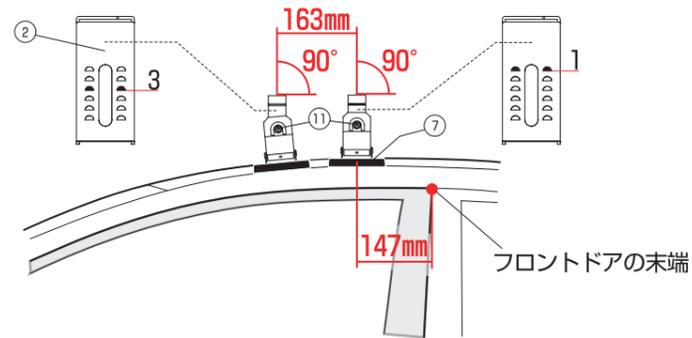
1セットはフロントドアの末端から前へ147mmの所に⑦ベースゴムの中心が来るように載せ、もう1セットはさらに163mm前方に載せます。
