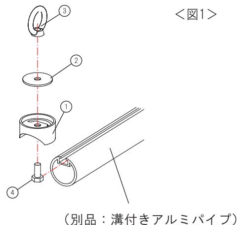
2. ガタツキは③アイナットM6のねじ込み量で調整してください。<図2>
