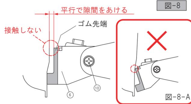
△注意 — ゴムの先端がバックドアと接触したままで使用するとバックドアが変形します。〔図-8-A〕
