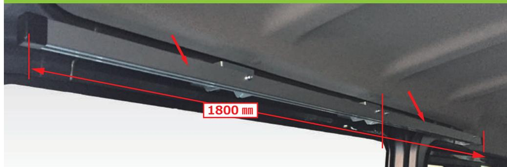
マルチレールは荷室上部側面に装備されている「ユーティリティナット」を利用しての取付けになります。(穴あけ加工不要)
