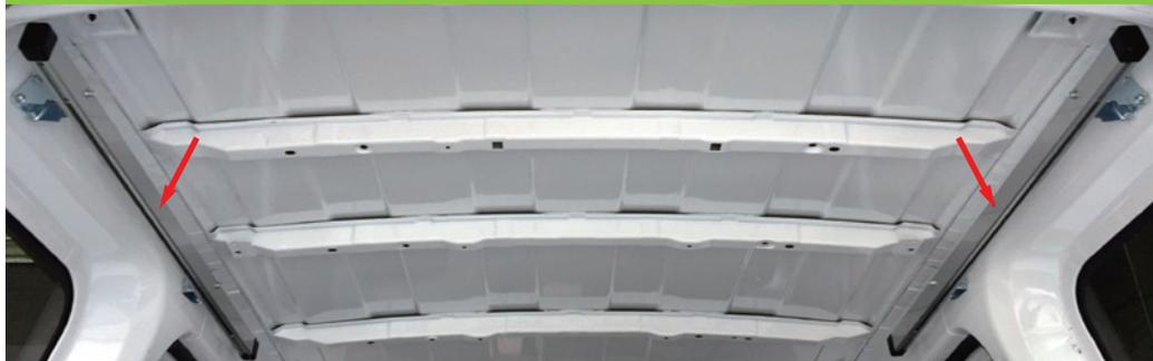
マルチレールは荷室上部側面に装備されている「ユーティリティナット」を利用した取付けになります。(穴あけ加工不要)
